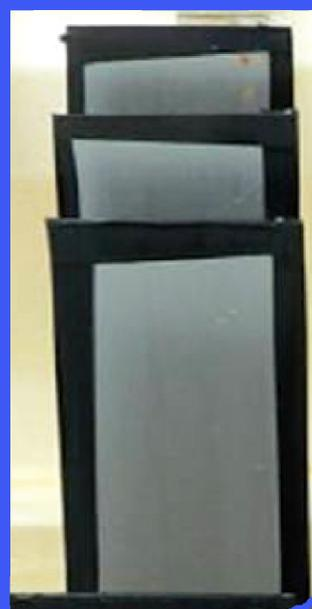
**EVOLUCION DE SUPERFICIE CORROIDA EN TEST ASTM B 117 (Corrosión en niebla salina)**
